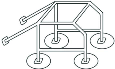
innen vorgeschriebenen Platten mit der Karosserie verschweißt sind. Die Hauptbügel an A- und B-Säulen müssen aus einem durchgehenden Rohrstück gefertigt sein. Die genannten Mindestanforderungen gelten sinngemäß für alle anderen Eigenbau-Überrollvorrichtungen in serienmäßig gefertigten Karosserien bei allen Wettbewerben, bei denen Überrollschutz vorgesehen ist.
